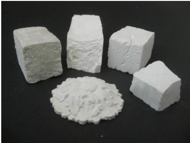
Afbeelding 4; De cementpasta in verschillende samenstellingen. Duidelijk is het verschil in structuur zichtbaar.
