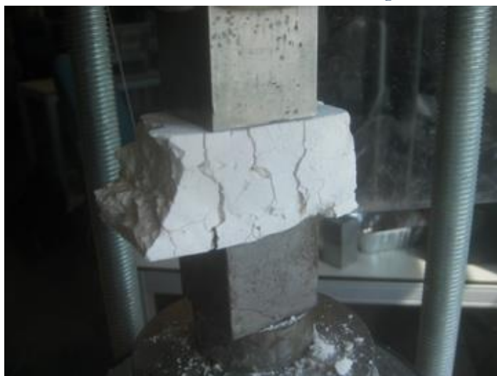
Afbeelding 3; Drukproef uitgevoerd aan de TU Delft.
